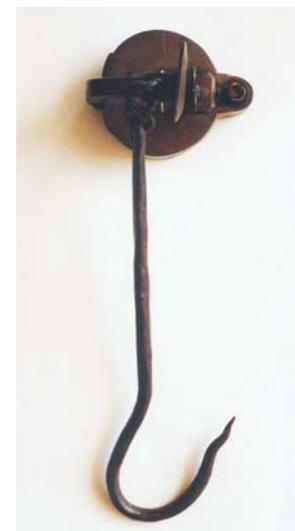
Abb. 92 Da sich im Strontianit-Bergbau kaum explosive Wetter (Methan-Luft-Gemisch) bildeten, konnten die Bergleute mit offener Flamme arbeiten. Die hier ausgestellte Lampe heißt „Frosch“.
