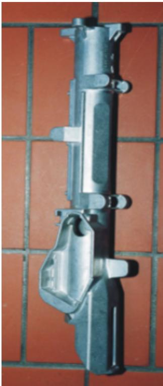
Abb. 73 Lenkradsäule aus einer Strontium-haltigen Silafont-36-Legierung, die in einen Mercedes der E-Klasse eingebaut werden kann. (34)
