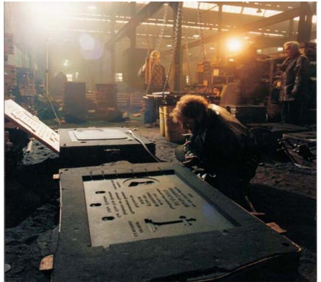
Abb. 21 Vorn die Form nach dem Gießen; links hinten die fertige Gedenktafel
