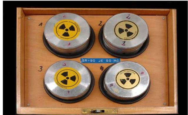
Abb. 97 Vier Strontium-90-Strahlungsquellen in Bleibehältern
