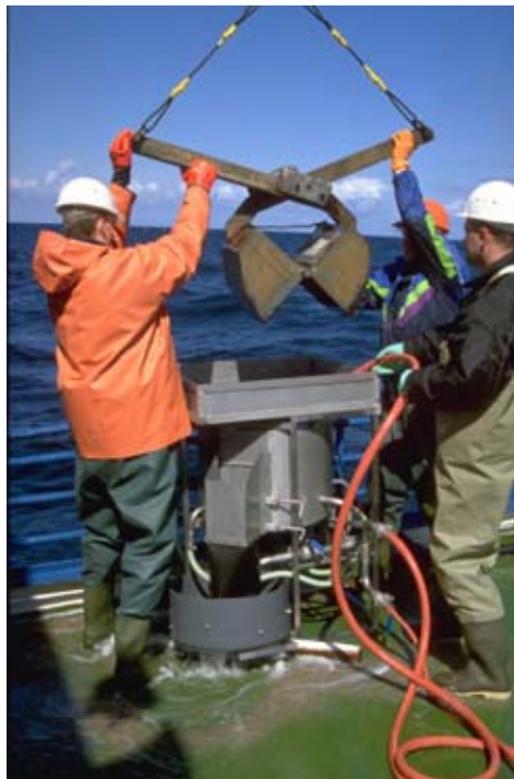
Abb. 2. Probenahme der Endofauna mit einem van Veen Greifer.
