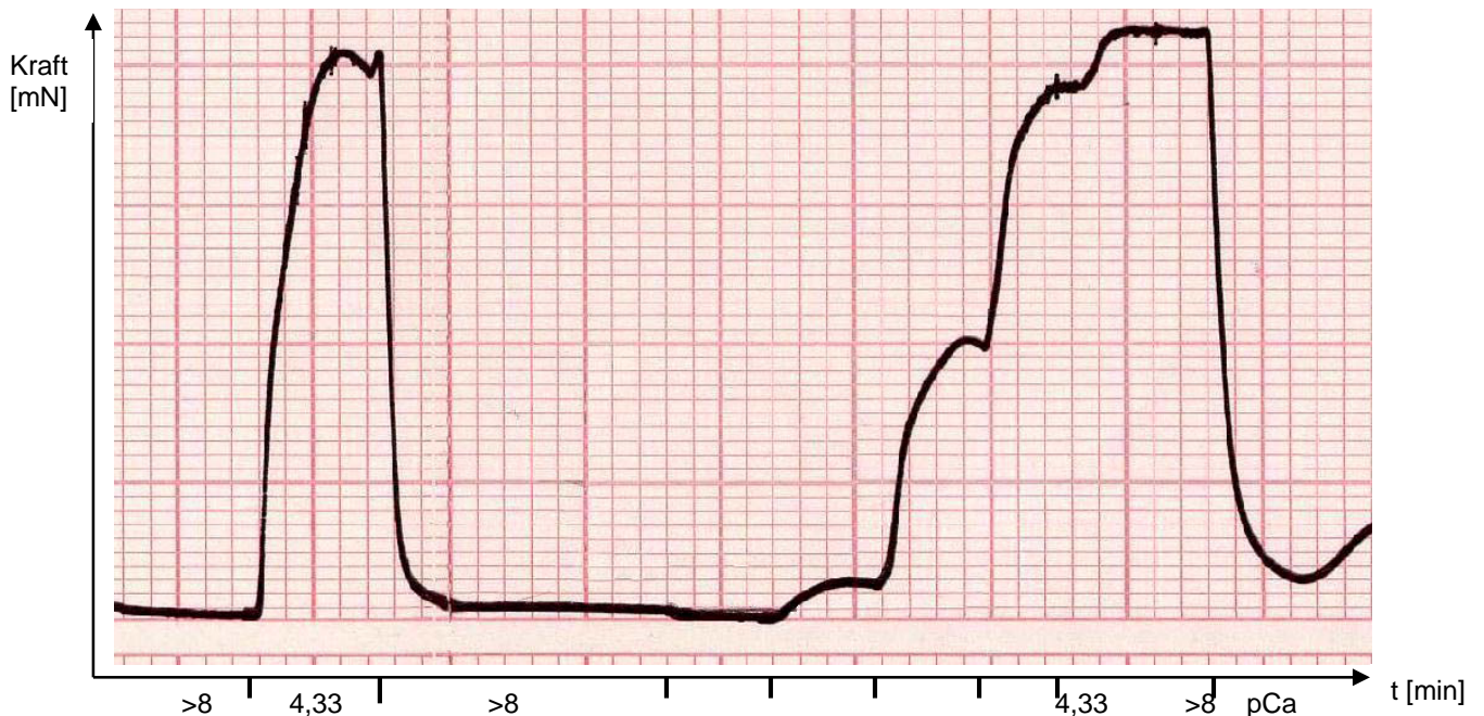
Abb. 6: Charakteristischer Kurvenverlauf der Kraftentwicklung nach kumulativer Steigerung der Ca^{2+} -Konzentration. Der Verlauf ist über die Zeit dargestellt, eine genaue Erfassung der Anstiegsgeschwindigkeit erfolgte hierbei nicht.
