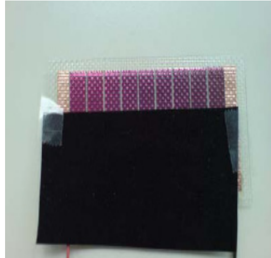
Abbildung 22: Teilweise abgedecktes, 9-zelliges, flexibles Modul
