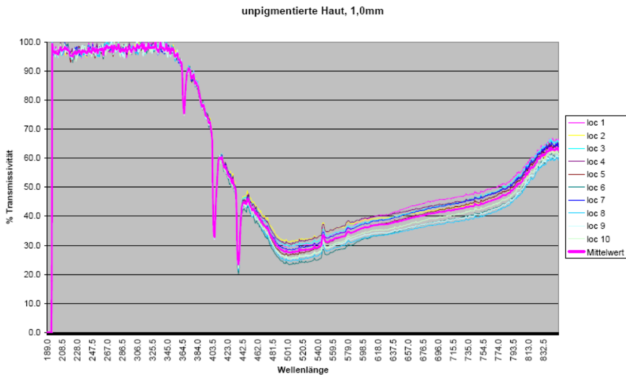
Abbildung 24: Transmissivität unpigmentiert 1,0mm Haut
