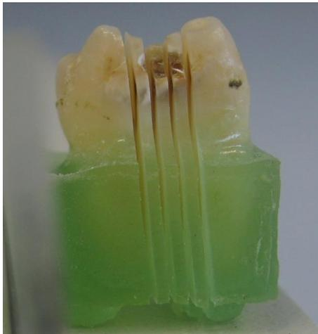
**Abb. 6-3:** Mit Hilfe des Trennschleifsystems wurden drei Dünnschliffpräparate pro Läsion hergestellt und anschließend auf Objektträgern fixiert. Zu Illustrationszwecken wurde in dieser Abbildung auf das den Zahn koronal fixierende, matt-transparente Technovit verzichtet, um die Schnitttechnik besser darzustellen
