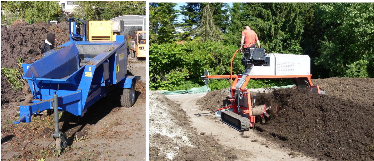
Abbildung 3.11: Grünschnitthäcksler (HFG II) der Firma Husmann (links) und selbstfahrender Kompostwender (GD, 250H) der Firma Gujer Innotec (rechts) beim Wenden einer Kompostmiete im BG
