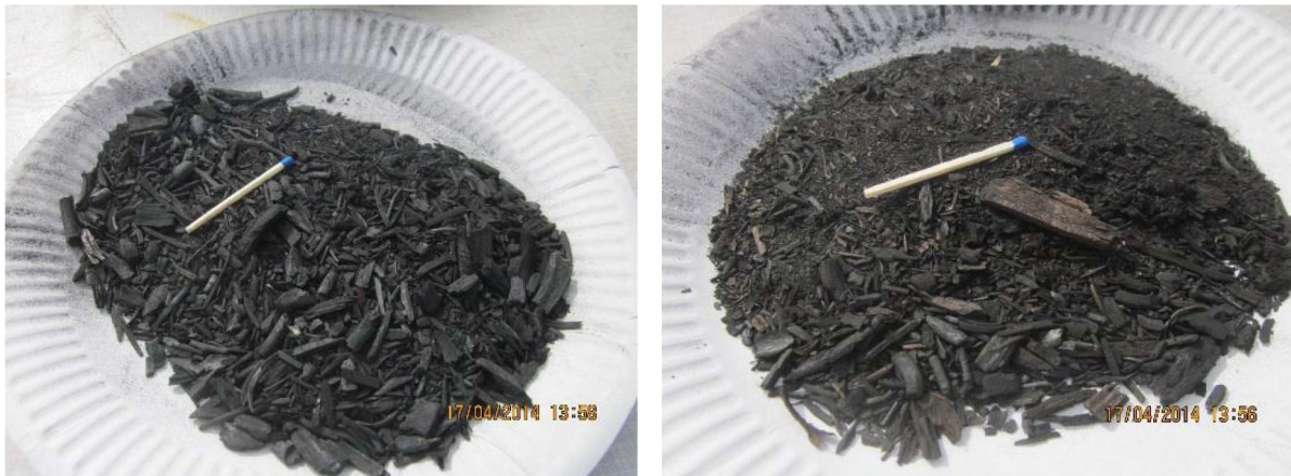
Abbildung 4.3: Pflanzkohle bei einem Durchsatz von 9,6 kg TM/h. Selbst größere Stücke sind bis zum Kern durchkarbonisiert (links); Pflanzkohle bei einem Durchsatz von 14,4 kg TM/h. Es sind vermehrt Stücke zu finden, die nicht richtig karbonisiert sind (rechts); Quelle Fotos: U. Suer (BioMaCon)
