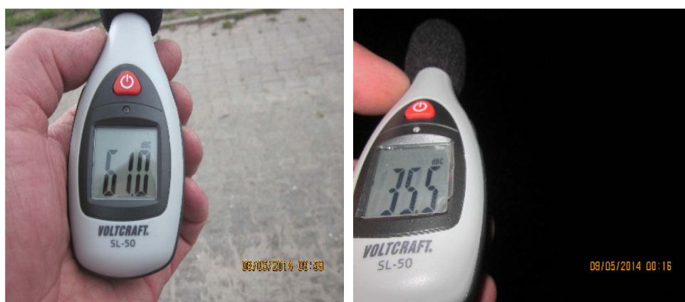
Abbildung 3.9: Messung des Schallpegels am Tage (links) und nachts am Zaun in Richtung Wohnhäuser (rechts)
