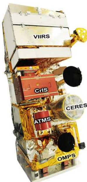
Abb. 12: die fünf Messinstrumente des Suomi NPP (NASA (2014))
