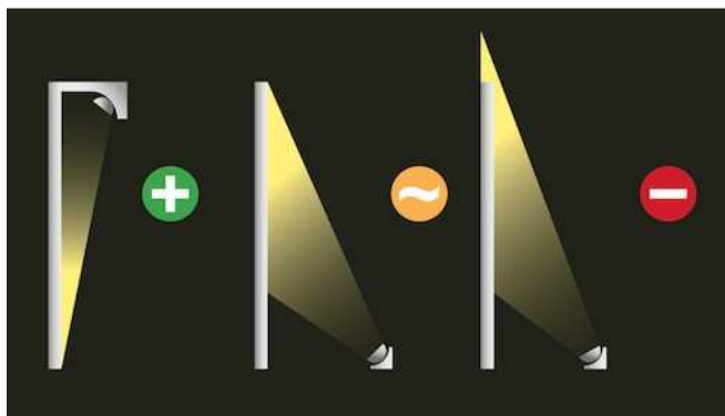
Abb. 23: links: optimales Beleuchtungskonzept, das Licht strahlt von oben nach unten; rechts: ineffektives Konzept, da das Licht direkt in den Nachthimmel strahlt (2014)
