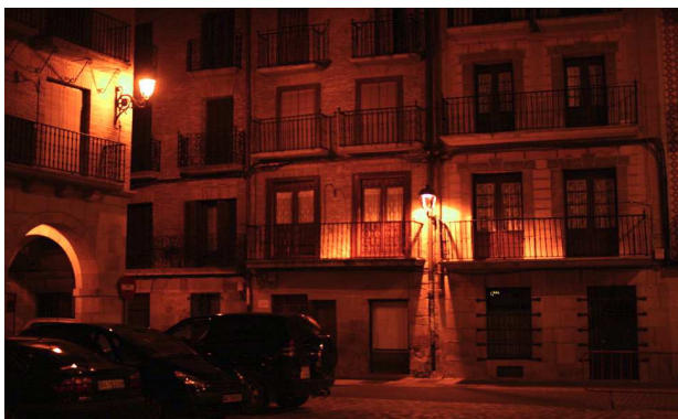
Abb. 7: linke Straßenlaterne schlecht konstruiert und ineffektiv, rechte Straßenlaterne abgeschirmt, sie strahlt nach unten (Hänel, A. (2013))
