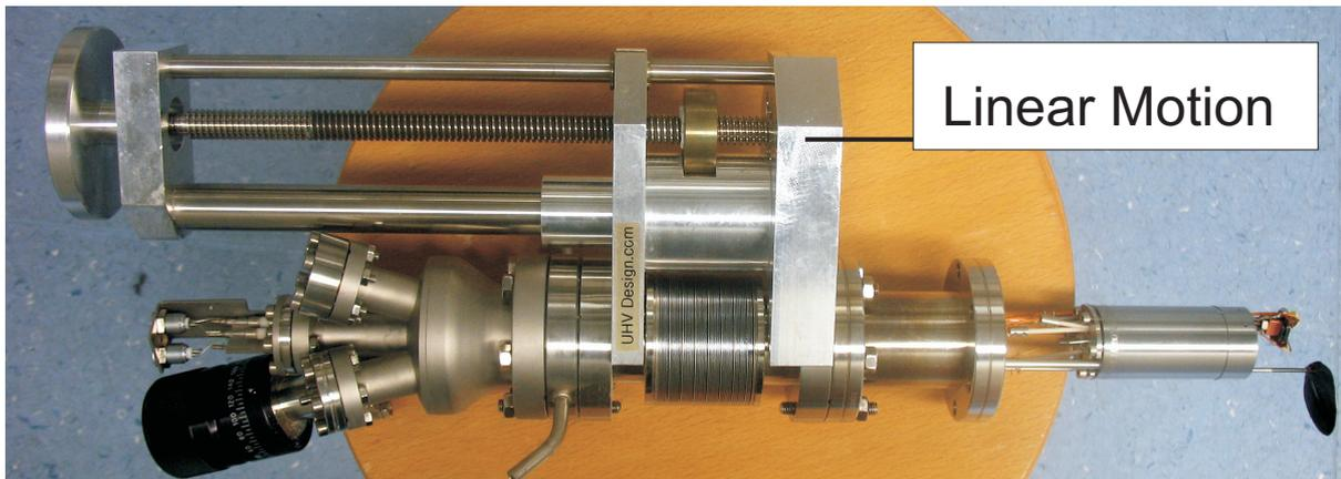
Abbildung 3.4.: Photographie des Molekülverdampfers mit Linear Motion.
