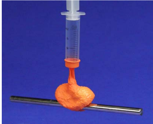
Abb. 1: Freihandversuch Granularer Greifer bestehend aus einem mit Granulat befüllten Luftballon und einer zuvor präparierten 20-ml-Einwegspritze
