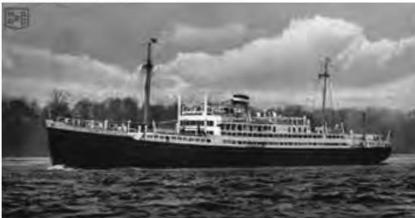
Das Dampfschiff Iberia war 1928 von F. Schichau in Danzig erbaut worden. Tonnage 9,829. Masse 460 x 60, 4 Schrauben, 15 Knoten. Getauft wurde es auf den Namen Rio Magdalena, umbenannt in Iberia, schließlich, unter sowjetischer Flagge, in Pobeda. In Betrieb war es bis 1980, 52 Jahre lang.
