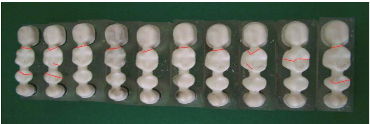
Abb. 37: 3. Serie mit rot markierten Bruchlinien zur weiteren Auswertung der Bruchmechanismen
