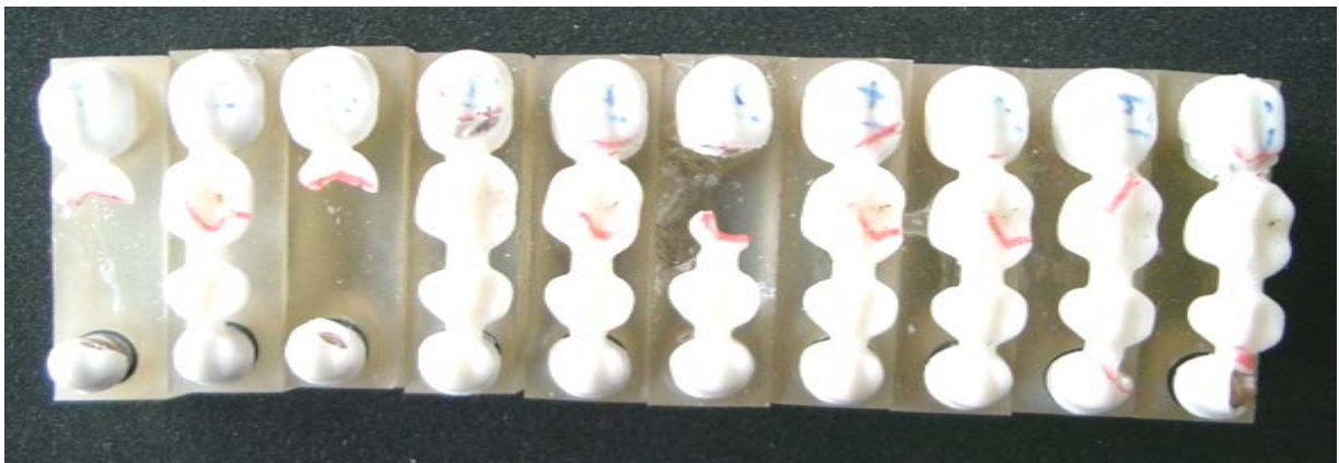
Abb. 40: 4. Serie mit rot markierten Bruchlinien zur weiteren Auswertung der Bruchmechanismen
