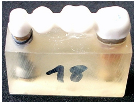
Abb. 38: Prüfkörper mit beweglichem Prämolar vor dem Versuch
