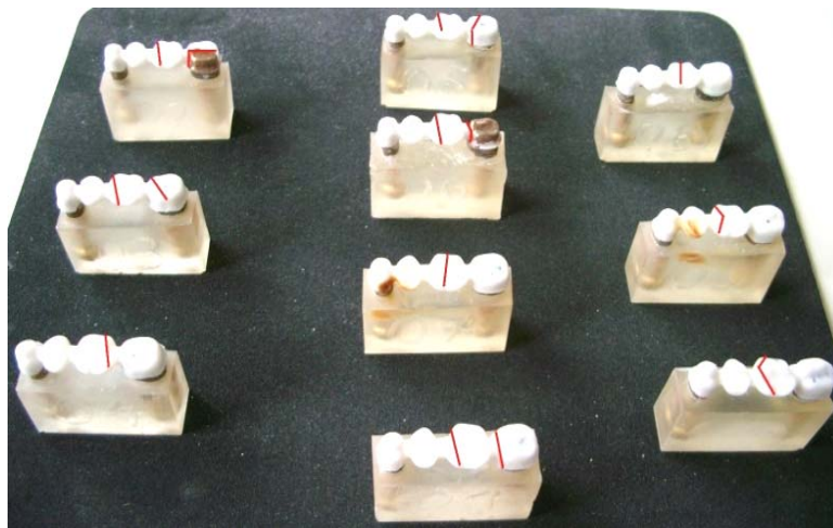
Abb. 31: 1. Serie mit rot markierten Bruchlinien zur weiteren Auswertung der Bruchmechanismen
