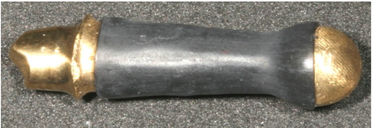
Abb. 17: Mit Schrumpfschlauch ummantelter Prämolar aus der Gruppe der beweglichen Metallstümpfe vor der Einbettung in Kunststoff
