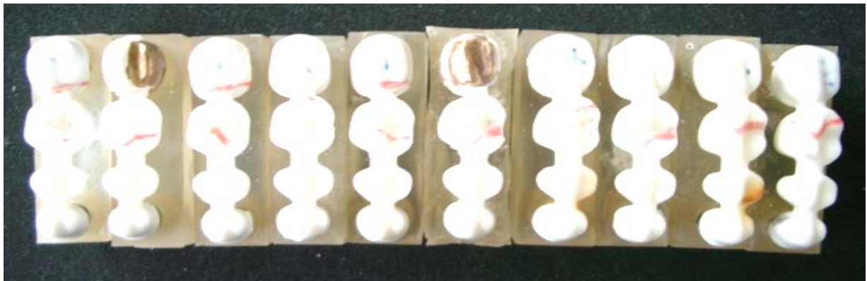
Abb. 34: 2. Serie mit rot markierten Bruchlinien zur weiteren Auswertung der Bruchmechanismen
