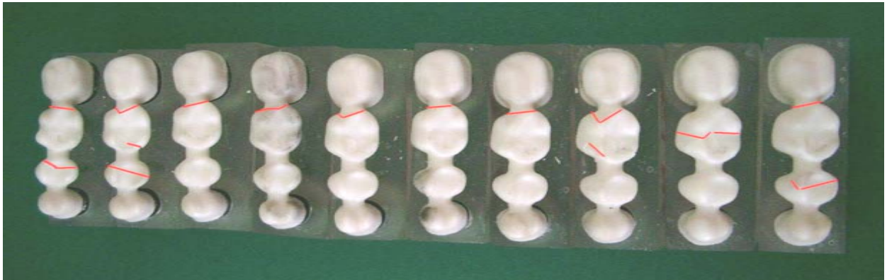
Abb. 27: Beispiel anhand der 3. Serie mit rot markiertem Bruchverlauf zur weiteren Auswertung der Bruchmechanismen
