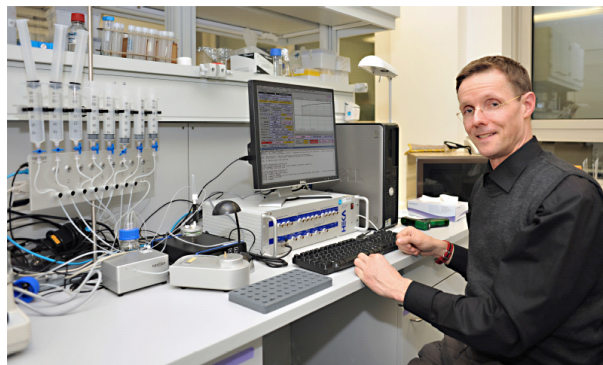
Der Biophysiker Dr. Stefan Mergler verwendet das kleinste Patch-Clamp-Setup der Welt, das sich im Forschungslabor der Klinik für Augenheilkunde am CVK befindet
