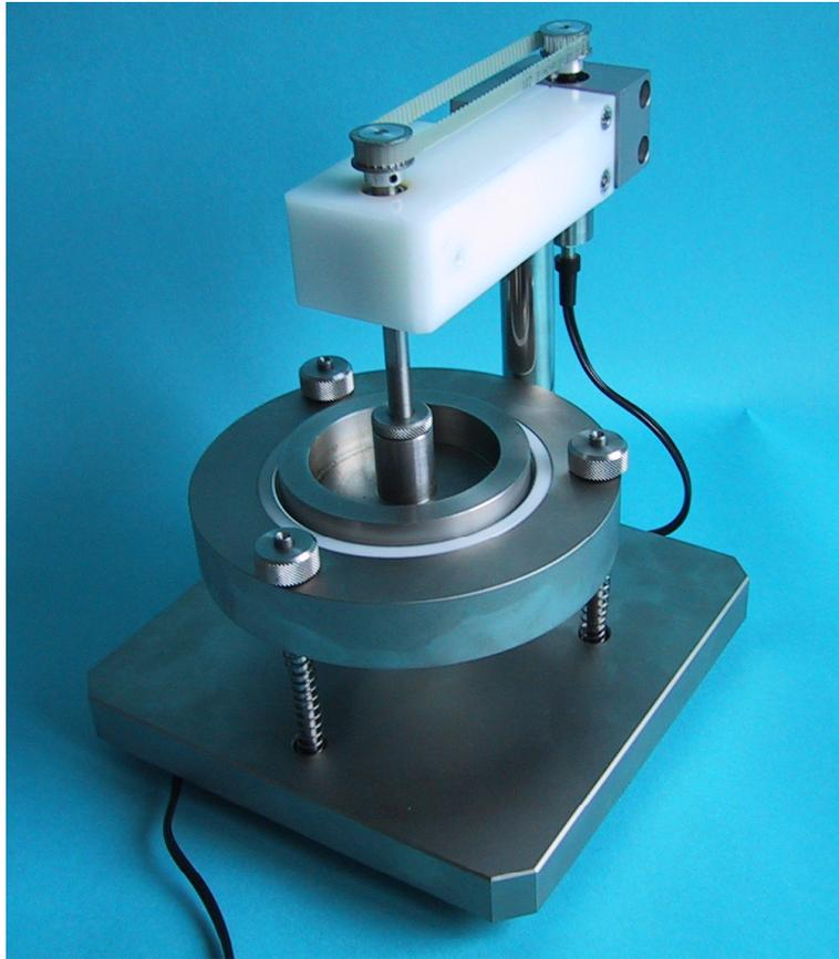
**Abb. 2-1 Kegel-Platte-System (Photo)**
