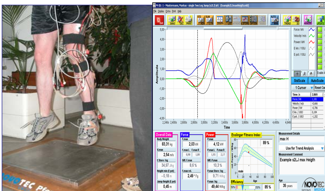
Abb. 10 Sprung auf der Mechanographie Messplatte und Auswertung der Daten
