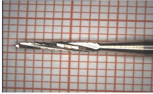
Abbildung 9: Knochenfräser mit ZrN-Hartbeschichtung
