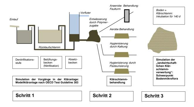
Abbildung 1: Verfahrensschema der Klärschlammbehandlung
