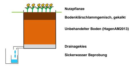
Abbildung 3: Skizze der Freilandlysimeter.
