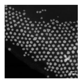
Abbildung 2: TEM-Aufnahme von NM-300K in Reinstwasser.
