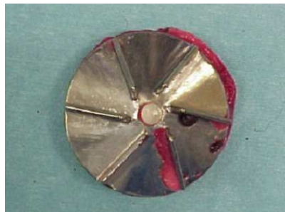
Abbildung 11: Thrombusbildung am Impeller der Zentrifugalpumpe
