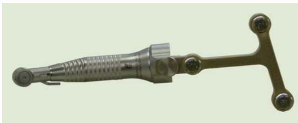
Abbildung 16: Passiver Lokalisator des chirurgischen Instruments mit Glaskugelreflektoren und Handstück des chirurgischen Instruments
