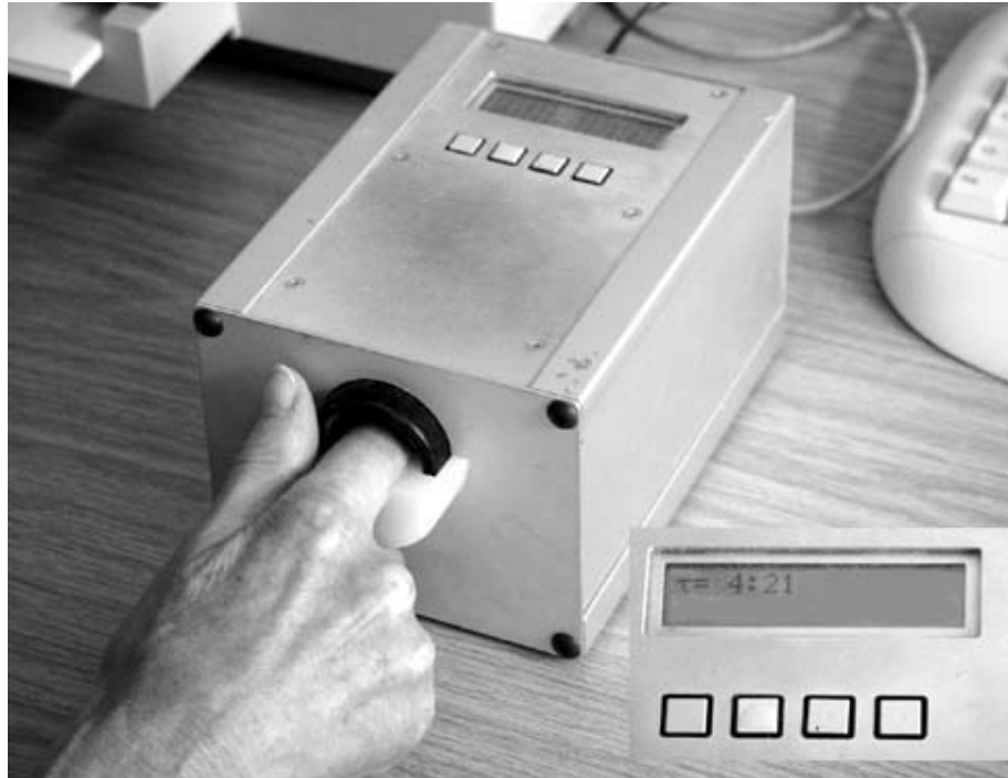
Abb. 4 Darstellung des Duosensors zur Messung der akralen Wiedererwärmung. Der Patient legt den Zeigefinger der rechten Hand nach einem definierten Kältereiz in die Messkammer.
