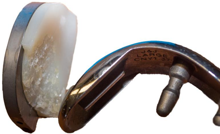
Abbildung 42: Unikondyläre Schlittenprothese (Johnson&Johnson) bei vorderer Kreuzbandinstabilität – unphysiologische Belastung des dorsalen Tibiaplateaus mit massivem PE-Abrieb. [Orthopädie, Brüderkrankenhaus Trier]
