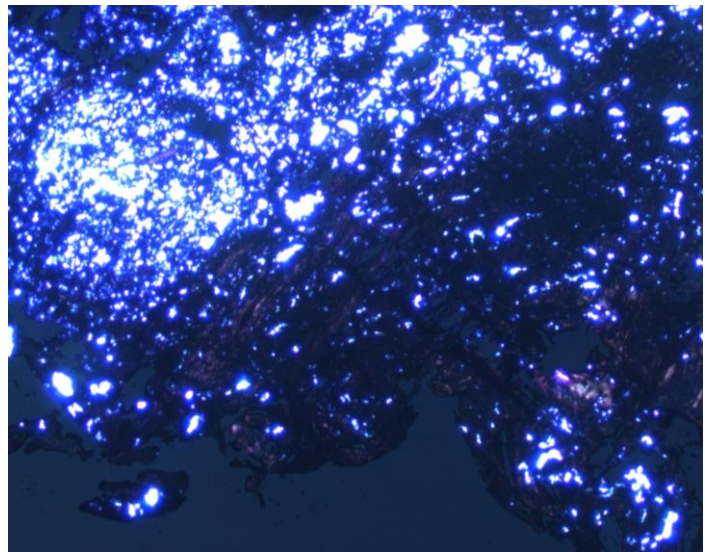
Abbildung 11: PE-Partikel einer Me-PE Gleitpaarung in der polarisationsoptischen Analyse,
