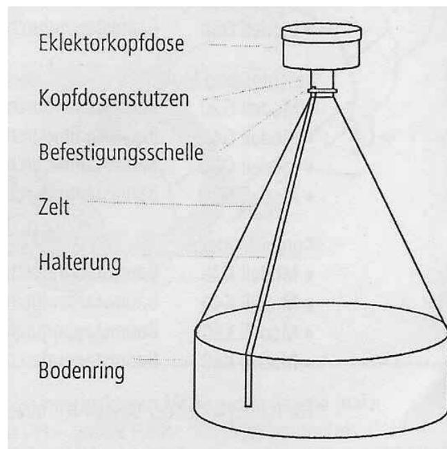
**Abb. 3.4:** Schematischer Aufbau eines Bodenphotoelektors
