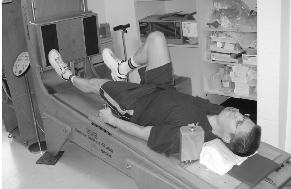
Bild 2. Proband trainiert in 6° HDT auf dem Galileo Space Sensor. Die Lasten lagen in beiden Interventionsgruppen zu Beginn bei 75 % des 1 RM. Bei der RVE Gruppe vibrierte die Standfläche während der Übungen zusätzlich mit Frequenzen zwischen 18 und 24 Hz.
