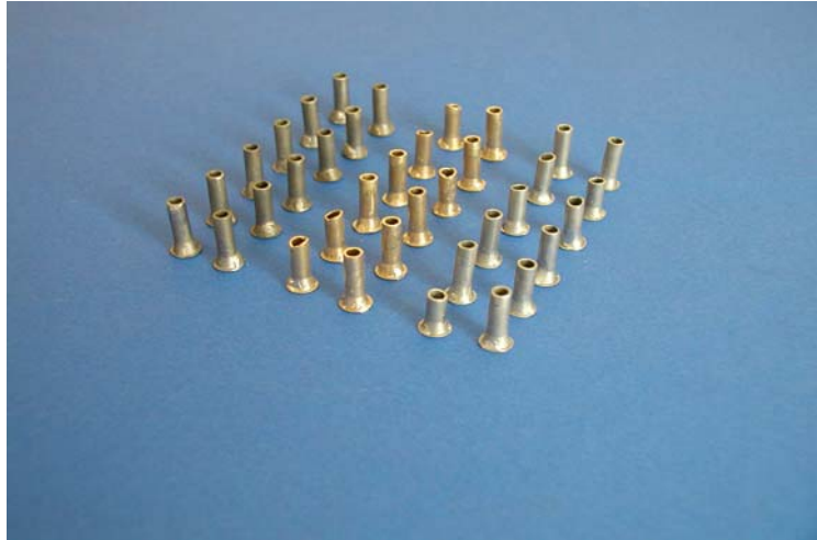
Abbildung 3-4: 36 Suprastrukturen, die für diese Studie hergestellt und vor und nach Funkenerosion auf ihre Oberflächenbeschaffenheit untersucht worden sind, links 12 Gerüste aus Titan, in der Mitte 12 aus Gold und rechts 12 aus Kobalt-Chrom
