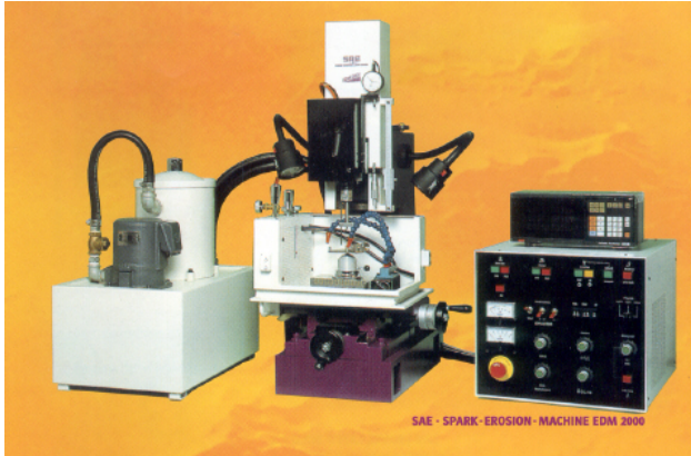
Abbildung 3-5: Funkerosionsmaschine EDM 2000 (Quelle: SAE Bremerhaven)
