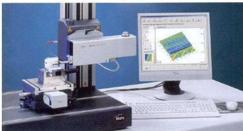
Abbildung 3-7: PC-basiertes Oberflächenmessgerät (Quelle: Firma Mahr)
