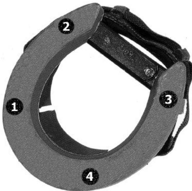
**Abbildung 27:** Räumliche Verteilung der Druckmeßpunkte
