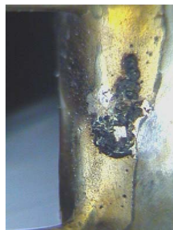
Abb.6.10 Korrosive Veränderungen mit Lochfraß beim Hartlot nach 487 Tagen Lagerung in Coca Cola light ( Probe 46 )
