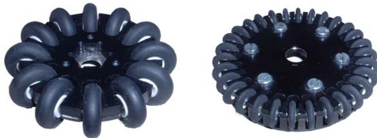
Abbildung 8.1: Die alten Omnidräder von 2002 haben 12 orthogonale Rädchen bei einem Durchmesser des Rades von 67 mm (links). Die Räder von 2004 haben 30 kleine Rädchen bei einem Raddurchmesser von 65mm (rechts). Durch die kleineren, empfindlicheren Rädchen sind die Räder jedoch auch höherem Verschleiß ausgesetzt, sodass nach jedem Spiel viele Rädchen ausgetauscht werden müssen.
