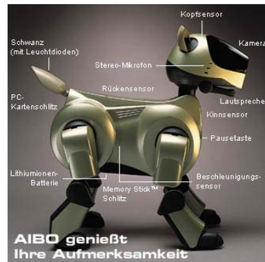
Abbildung 2.6: Sonys Roboter AIBO mit seinen wichtigsten Sensoren und Aktuatoren. Bild von der Sony Webseite.
