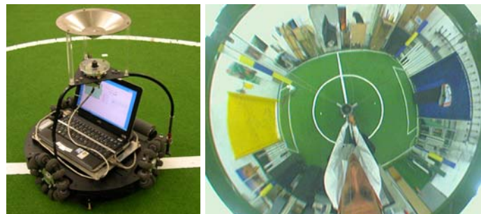
Abbildung 2.5: Ein dreirädriger, omnidirektionaler Mid-Size-Roboter der FU-Fighters von 2003. Eine preiswerte FireWire Kamera ist nach oben zu einem konvexen Spiegel ausgerichtet, durch den das ganze Spielfeld zu sehen ist. Ein Sub-Notebook wertet die von der Kamera gelieferten Bilder aus, gleicht sie Daten mit den anderen Robotern ab und steuert den Roboter. Rechts ist ein Bild zu sehen, wie es die lokale Kamera liefert. Der Spiegel oberhalb der Kamera ermöglicht eine 360° Sicht; das Bild wird dadurch allerdings stark verzerrt.
