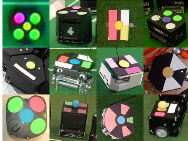
Abbildung 2.3: Die Farbcodierungen einiger Teams aus der Small-Size-Liga. In der Mitte ist der so genannte Teammarker — blau oder gelb. Alle anderen Farben sind frei wählbar, dürfen allerdings nicht zu sehr den vorgegebenen Farben — orange für den Ball, gelb und blau für die Teamfarbe — gleichen. Die Farben sind immer ein Anlass für lebhafte Diskussionen vor einem Spiel, denn jedes Vision System sieht, abhängig von den verwendeten Algorithmen, der Beleuchtung und der verwendeten Kameras, die Farben unterschiedlich.
