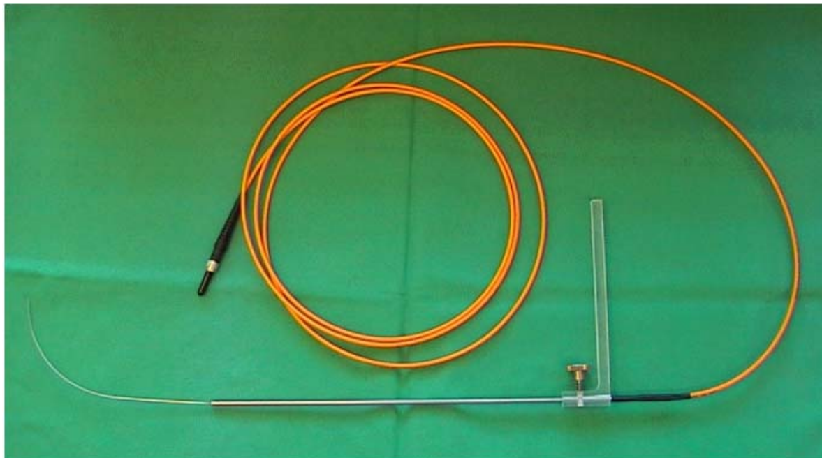
Abbildung 4.7: Sonde für die Messung der Autofluoreszenz am ex-vivo perfundierten schlagenden Schweine-Herz
