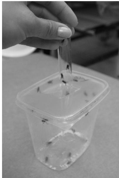
**Abbildung 6:** Überführen der Fliegen in den mit Insektizid befüllten Testbecher beim Fütterungstest
