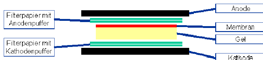
Abb. 2 Anordnung der einzelnen Komponenten beim Semi-Dry Blotting
