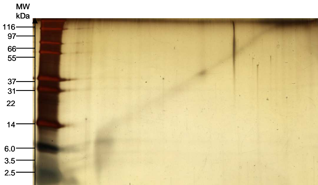
Abb. 156: SDS-Gel der Fraktion 34 aus der Größenausschlusschromatographie (7 kDa-Molybdän-bindendes Protein) rechts; Markerprotein links
