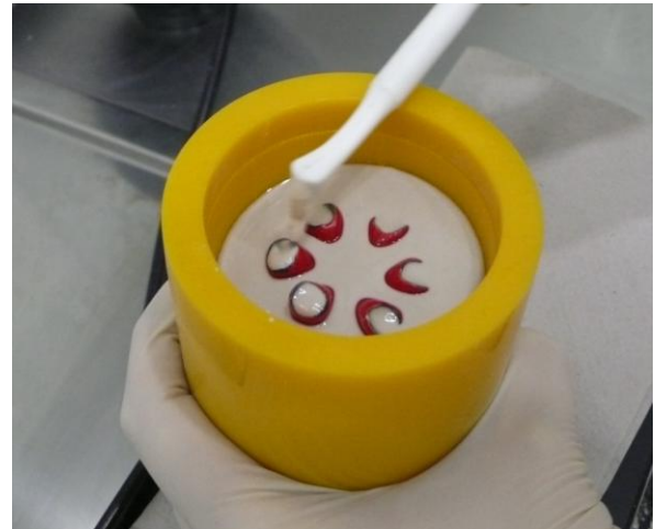
Abb. 7: Einbetten der aufgewachsenen Prüfkronen
