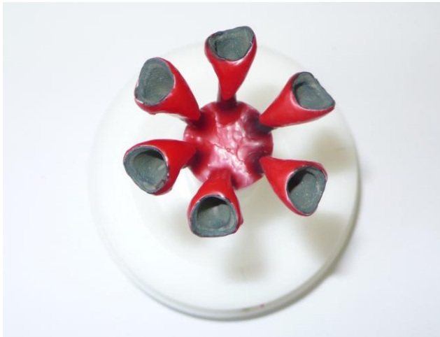
Abb. 6: Zum Einbetten angestiftete Kronen auf Presssockel
