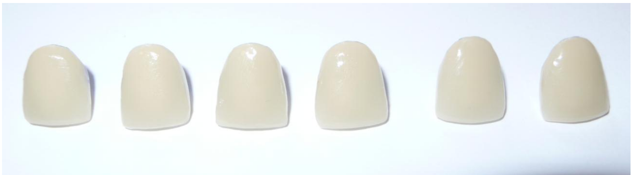
Abb. 9: vollgepresste Prüfkronen nach Glanzbrand
