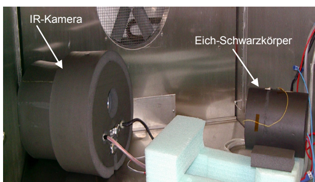
Abb. 13: Eichprozedur in DLR-Klimakammer
