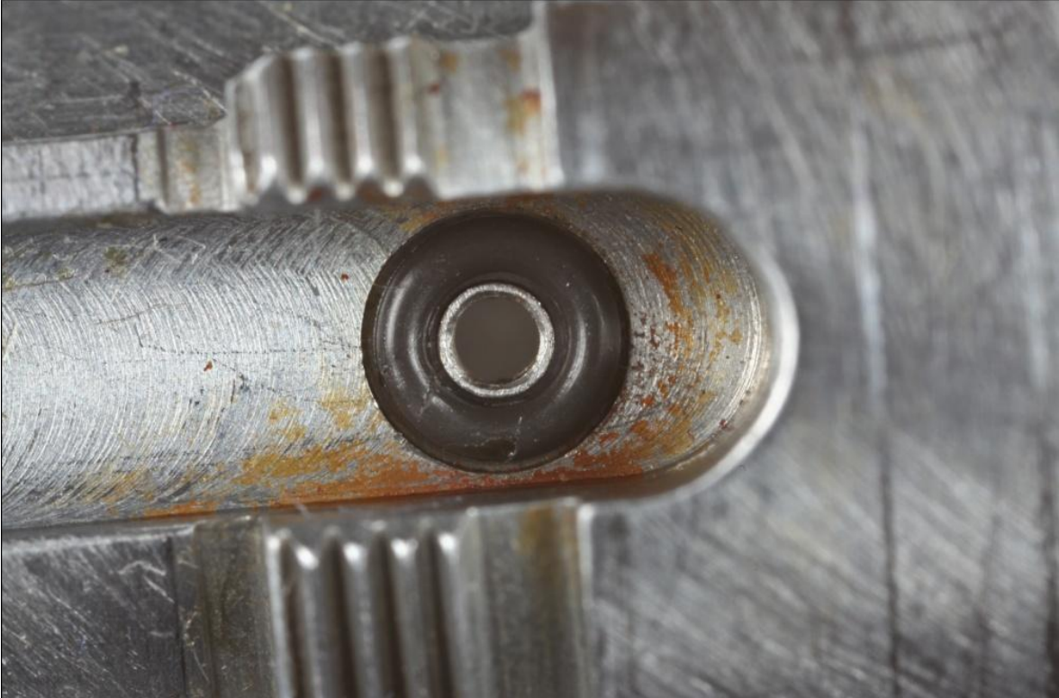
Abb. 16: Darstellung der Schnittstelle des Spraywasser-/Sprayluftkanals mit dem HWS mit O-Ring
