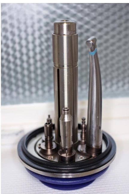
Abb. 5: Spezialdeckel des DAC Universal Geräts mit Adaptern und aufgestecktem HWS
