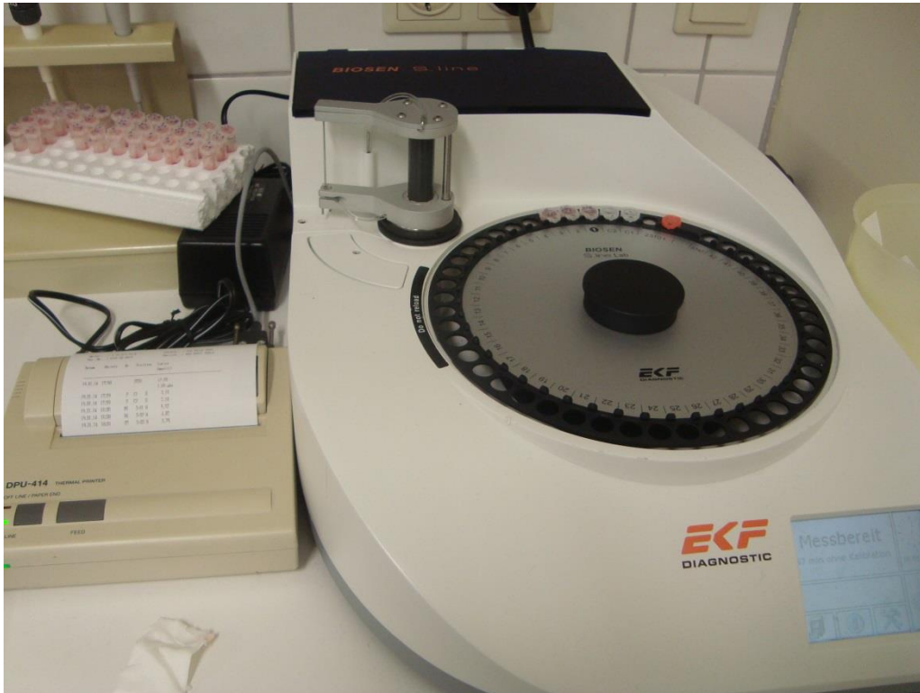
Abbildung 6: Messgerät „Biosen S_line lab“ zur Laktatbestimmung, Firma EKF-Diagnostic. Eigene Darstellung.
