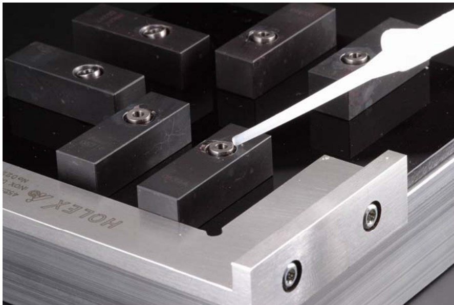
Abb. 11: Befestigung der präfabrizierten Prüfkörper
