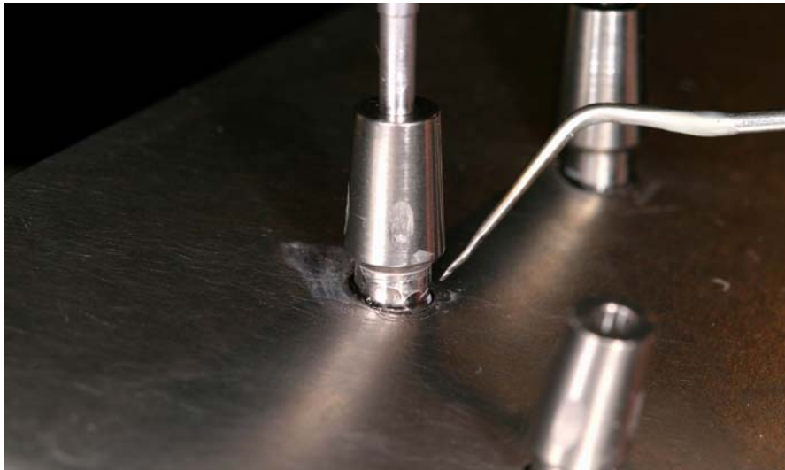
Abb. 9: Vorfixierung der Implantatbestandteile im Metallblock
