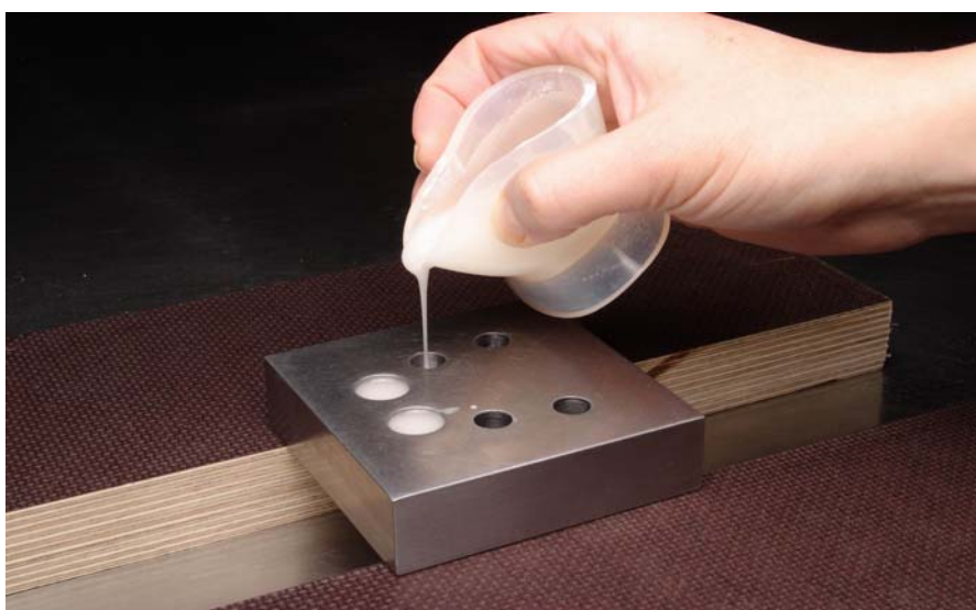
Abb. 10: Einfüllen des Kaltpolymerisats zur Fixierung
