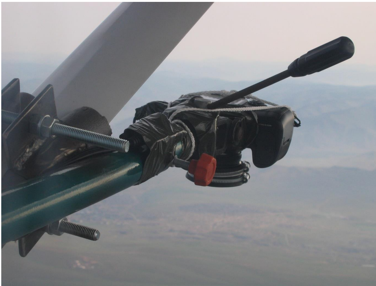
Abb. 43 Halterung für die Kamera, angebracht am Flugzeug (Foto 29.07.2007: Teusan)
