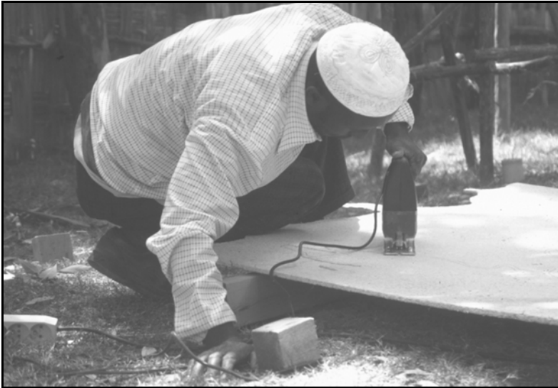
Abbildung 92a: Aussagen der Höhenschichten aus Spanplatten
