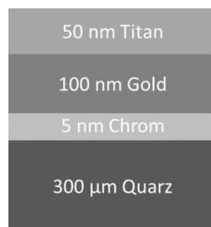
Abb. 4.69 Querschnitt der Titanbeschichteten Quarzsensoren.
