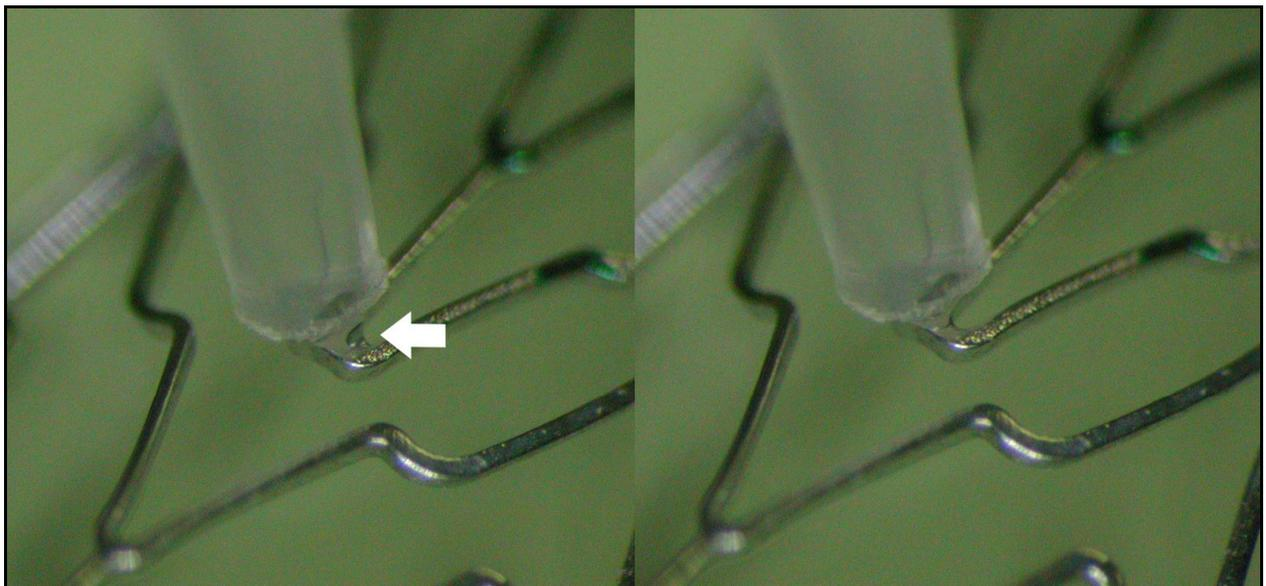
**Abb. 4: NiTi- Stent mit 1%NaCl, Auflichtmikroskop (25x), links: beginnender Elektrolytaustritt (siehe Pfeil); rechts: nach Aspiration**
