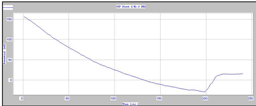
**Abb. 14: OCP FeCrNi dilatiert mit PBS (Stent Q, Ms. 6): der Potentialanstieg bei 200sec. korreliert zeitlich mit der Aspiration austretender Elektrolytlösung**
