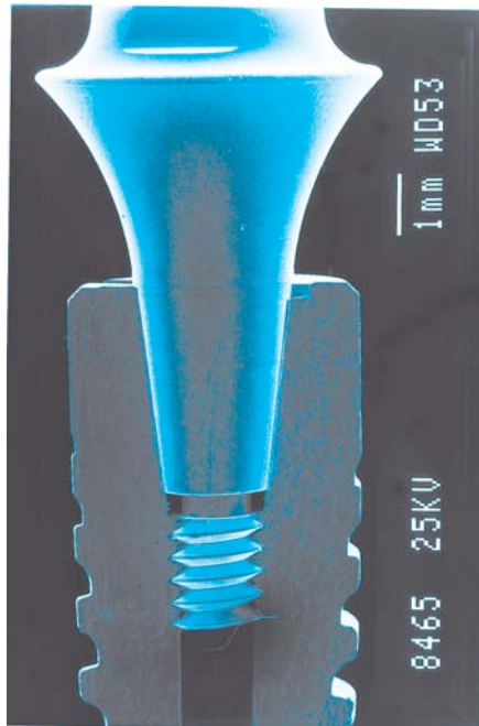
Abbildung 5: Rasterelektronenmikroskopische Aufnahme der Konusverbindung zwischen Aufbauteil und Implantat (Foto Dentsply Friadent, Mannheim, D.).
