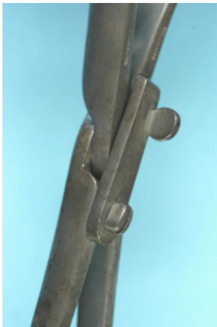
Abb. 52a Zange nach Osiander Schlosskonstruktion mit geschlossener Sperrvorrichtung
