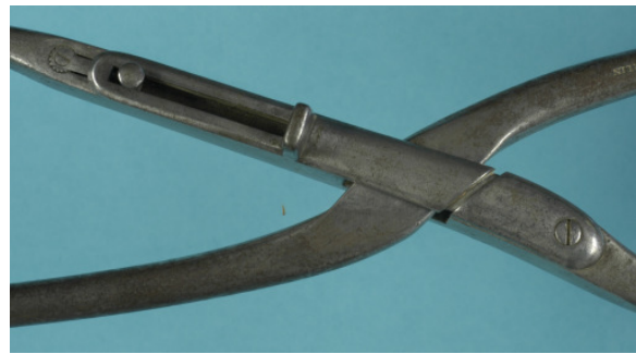
Abb. 45b Zange nach Santarelli Detaillaufnahme des Schlosses mit geschlossenem Schieber
