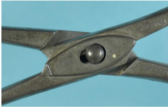
Abb.22a Zange nach Grégoire, Detailaufnahme der Schloss-Konstruktion
