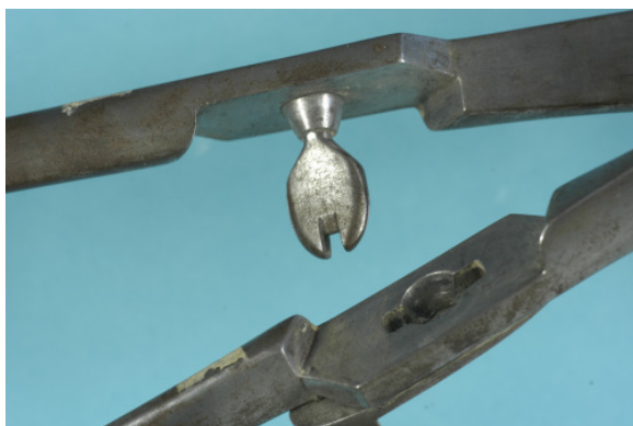
Abb.27a französisches Steckschloss, geöffnet
