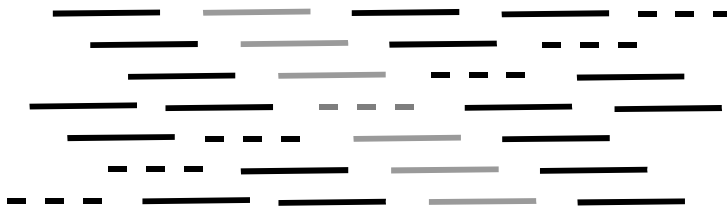
Abb. 2.2.2: Mauerwerkstruktur als zweidimensionale Erweiterung der linearen Kette. Die in der Struktur enthaltene Kette nächster Nachbarn aus Abb. 2.2.1 ist grau hervorgehoben. Gestrichelt gekennzeichnet ist eine Kette von Molekülen, die untereinander die übernächsten Nachbarn bilden.
