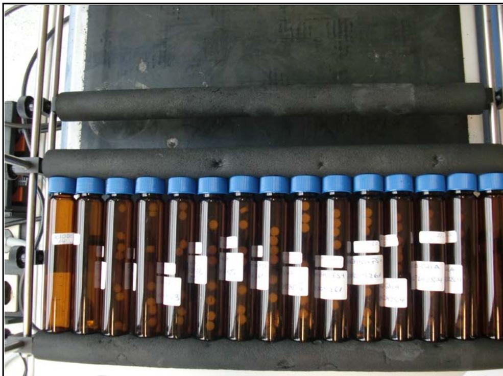
**Abbildung 8: Horizontalschüttler mit eingespannten Probengefäßen**
