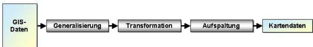
Abb. 17.2 - Dreistufiger Prozess der Datengewinnung und -reduktion.
