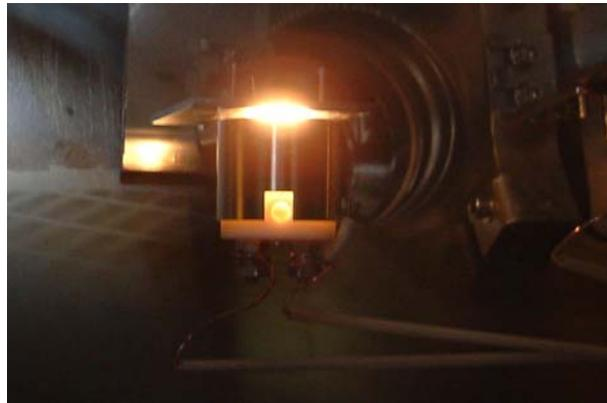
**Abbildung 5.7.2:** Der Kristall beim Ausheilen (Tempern). Er glüht gelb-weiß infolge der hohen Temperatur während des Elektronenbeschusses.
