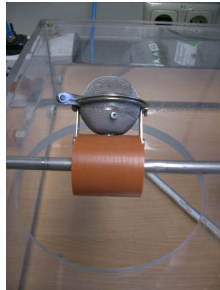
Abbildung 11: Freisetzungsapparatur (IMST) zur Untersuchung von Arzneiformen unter erhöhter mechanischer Belastung
