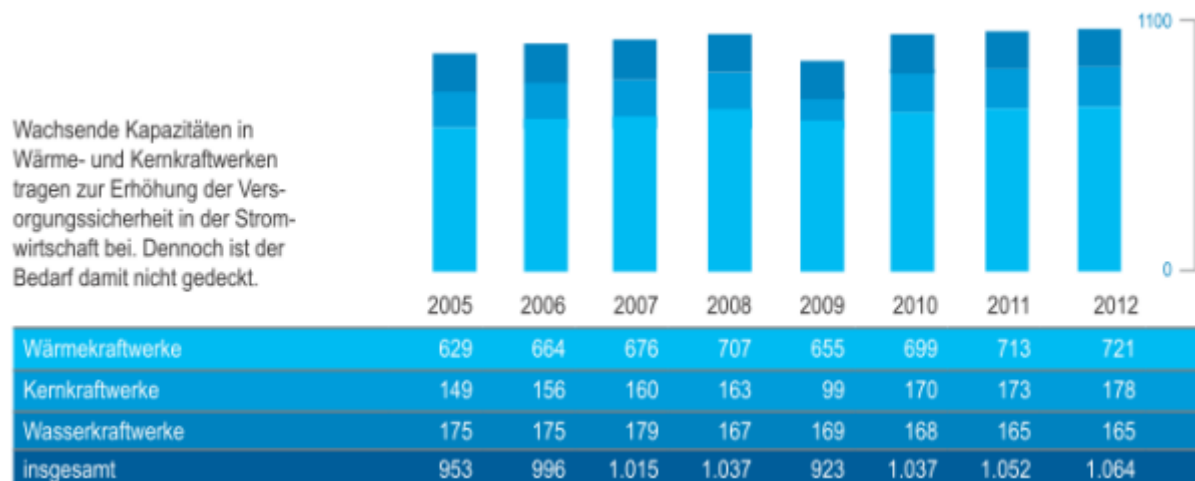
Abbildung 7: Stromerzeugung in der Russländischen Föderation 2005-2012 nach Kraftwerken in TWh
