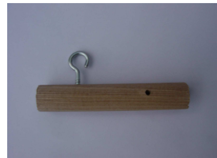
Abb.:4 Vierkant in Holzprobe als Analog zum press fit-Implantat
