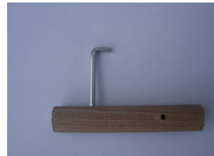
Abb.:4 Vierkant in Holzprobe als Analog zum press fit-Implantat
