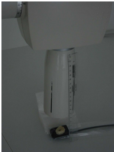
Abb.:26 Knochenprobe auf Röntgensensor mit Objekt-Tubus-Abstand von 5 cm
