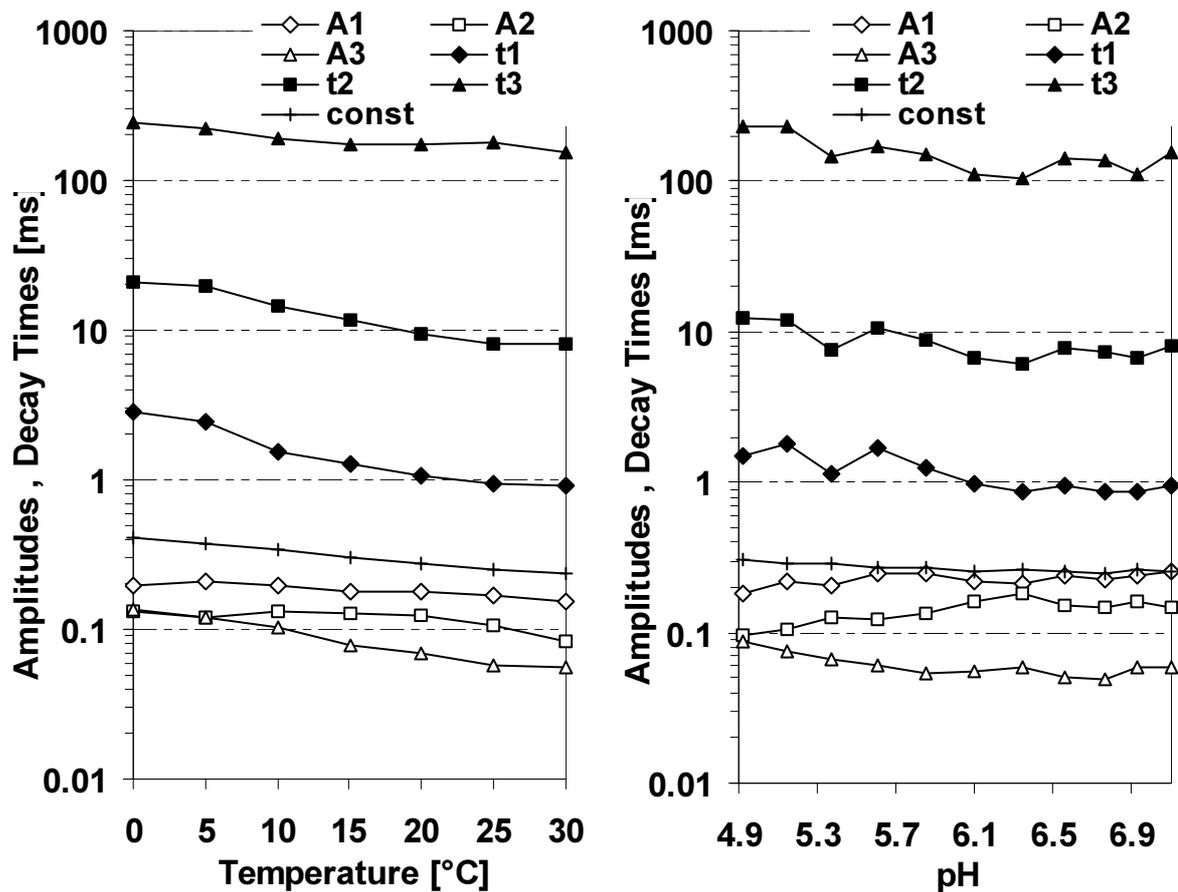
Dargestellt sind die Zeitkonstanten und Amplituden der 3fach-exponentiellen Beschreibung der Abfälle der prompten Fluoreszenz nach Anregung mit einem sättigenden Laserpuls für den dritten Blitz. Links: Temperaturabhängigkeit bei pH 6,4, rechts: pH-Abhängigkeit bei 20 °C.
