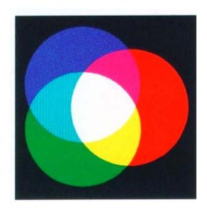
Abbildung 12: Additive Farbmischung
